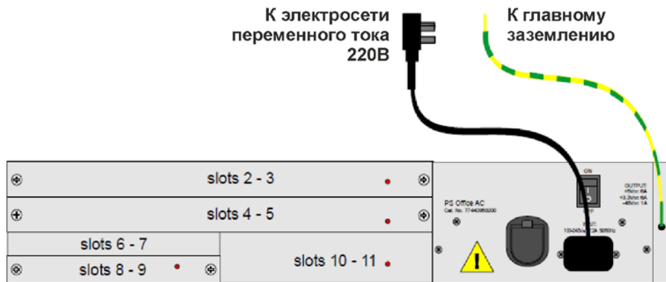
Рисунок 24. Схема подключения электропитания переменного тока 220В к УПАТС Коралл-Р 200.
